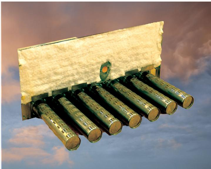
**L**es chaudières OPTIMUM sont équipées d'un brûleur à gaz atmosphérique de nouvelle génération. ces brûleurs à prémélange total, sans air secondaire à allumage électronique et au fonctionnement très silencieux, favorise une consommation réduite d'énergie et de très faible rejets d'oxyde d'azote. Les surfaces d'échanges thermiques optimisées du corps de chauffe, son isolation renforcée contribuent à l'augmentation de la performance et à la propreté de la combustion.
